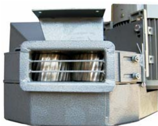
Vista uscita macinato Rulli in acciaio
